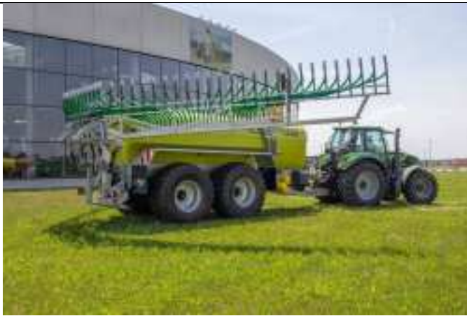
7 Keine abknickende Auslaufschläuche durch speziellen Klappmechanismus
