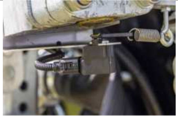
6 Winkelsensoren links und rechts für gleichmäßiges Aus- und Einklappen am Hang
