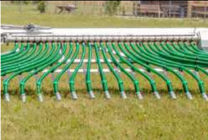
11 Gleichmäßige Verteilqualität durch kurze Auslaufschläuche
