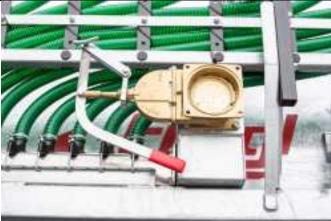
1 Staukastenöffnung mechanisch oder hydraulisch
